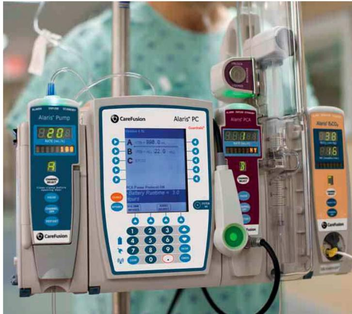
Una **pompa di infusione** è un dispositivo elettronico in grado di distribuire nel corpo umano fluidi sia in maniera continua che periodica ed è utilizzato per il controllo della **velocità di somministrazione** della terapia infusiva.
